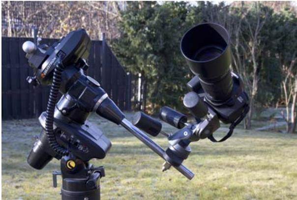
Abbildung 1: Canon EOS 60Da mit EF 200mm f/2.8L auf einem 3D-Neigeckopf an der Deklinationsschse einer parallaktischen Montierung mit motorischer Nachführung.
