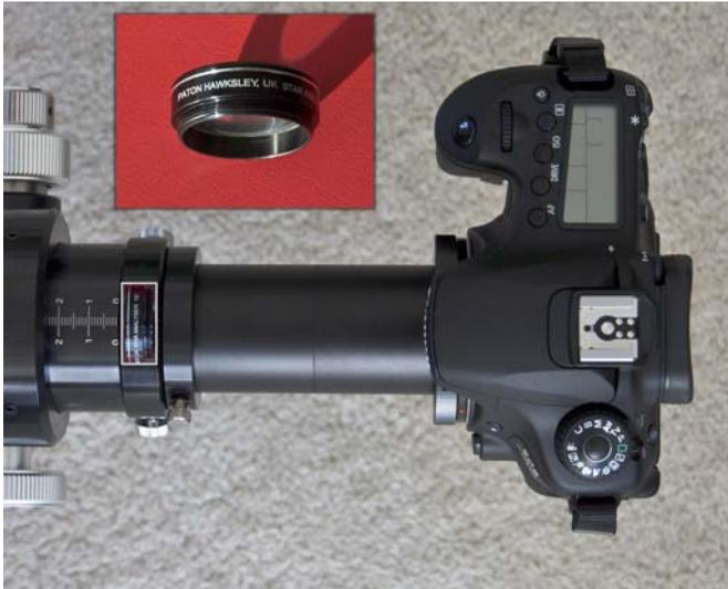
Abbildung 3: Instrumenteller Aufbau des Spektrographen am Okularauszug eines 127mm-Apochromaten f/7.5 mit Verbindungsadapter mit eingesetztem Gitter, Distanzhülse und DSLR-Kamera. Die Position des Gitters ist markiert. Die Projektionsdistanz beträgt 155 mm.
